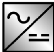
Figure 3.9: Rectifier in AVEVA.
