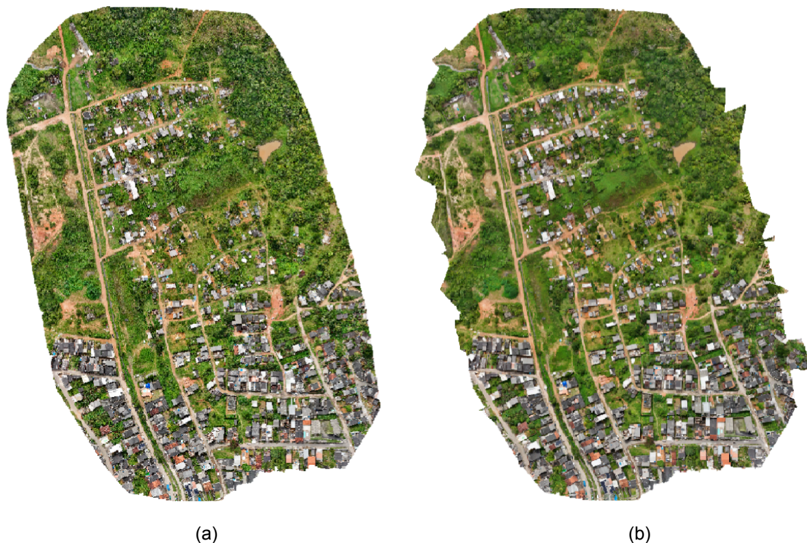
FIGURA 8 - ILUSTRAÇÃO DOS ORTOMOSAICOS (a) DTM (b) METASHAPE
