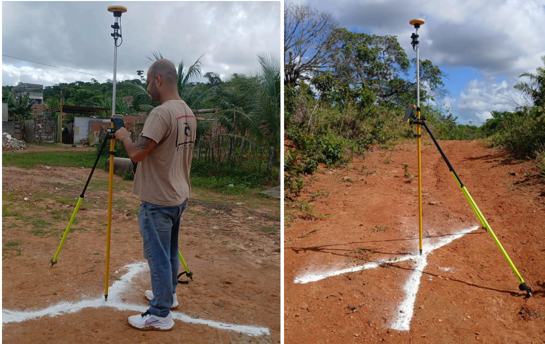
FIGURA 7 - RASTREIO DOS PONTOS DE CHECAGEM
