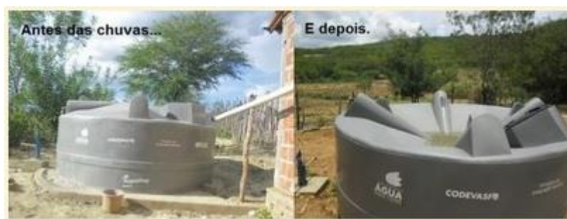
Figura 08 – Cisterna de polietileno deformada pelo clima quente no Cedro – Ceará - 2012
