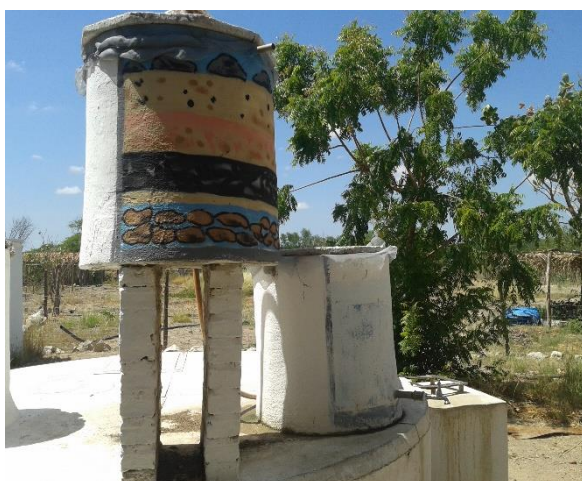
Filtro onde colhia minha água de beber Tecnologia difundida pelo IRPAA
