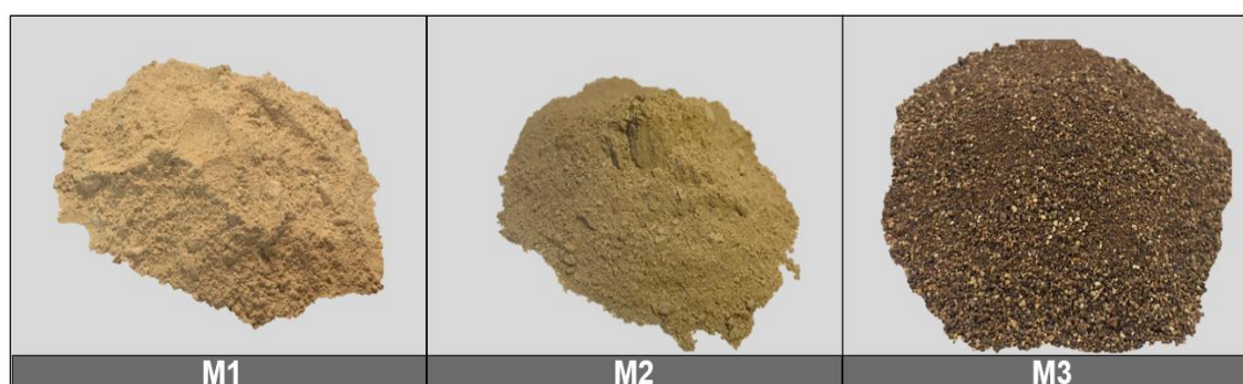
Figura 15. Sínteres magnesianos utilizados na pesquisa com três diferentes granulometrias (M1, M2 e M3).
