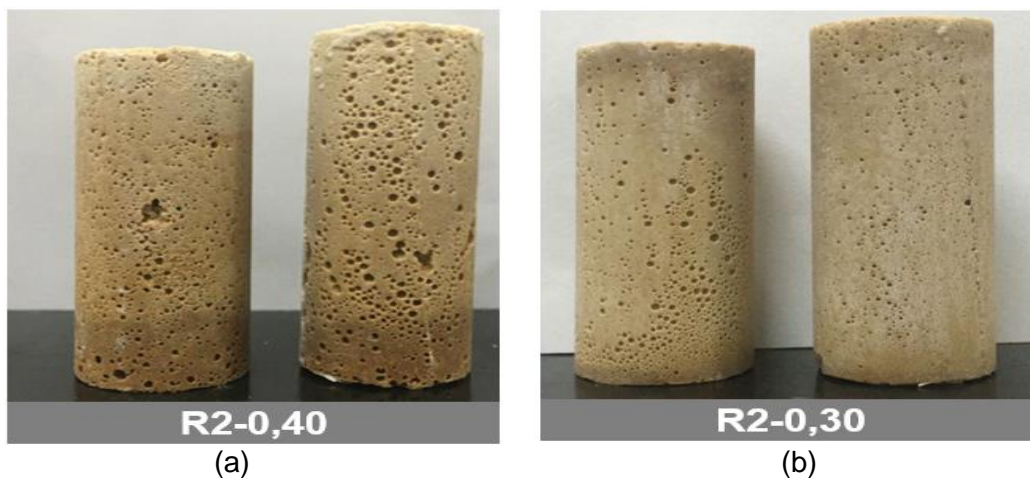
Figura 20. Corpos de prova de CFM, com traço R2, moldados com razão a/l iguais a 0,40 e 0,30.
