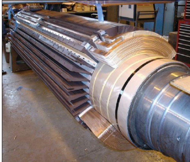
Figura 19 – Rotor de polos lisos. Fonte: WEG (2011).
