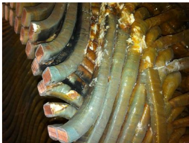
Figura 36 – Envelhecimento da isolação. Fonte: Penrose (2013).
