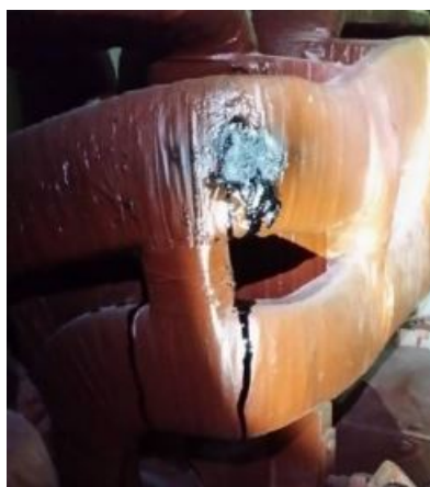
Figura 35 – Deterioração das isolações sólidas do estator.
