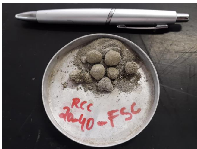
Figura 51 – Efeito “ dusting ” nos clínqueres calcinados à 1340°C e resfriados a 53°C/min.
