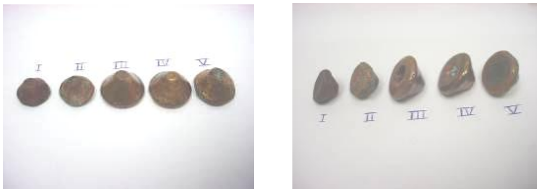
Figura45: Botões de cobre obtidos pela técnica de FA usando CuO como coletor.
