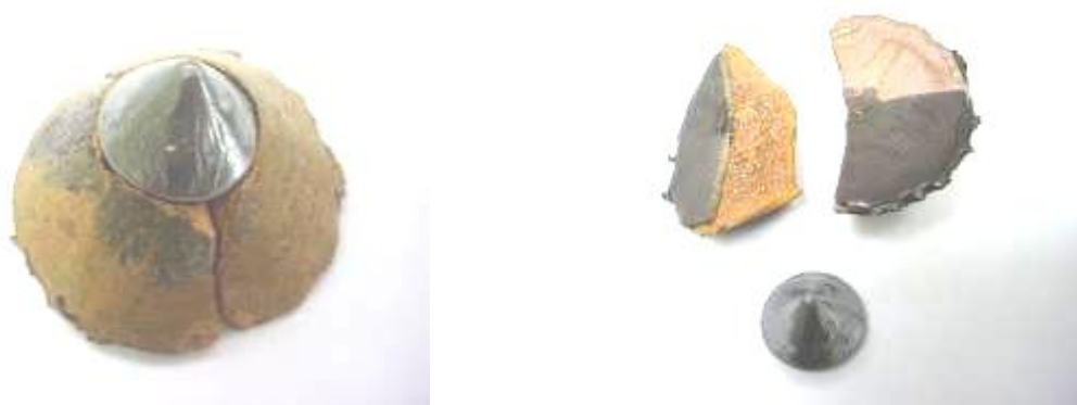
Figura 46: Botão de cobre obtido e sua respectiva escória.
