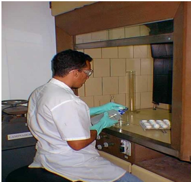
Figura 5: Etapa de partição: digestão da liga para separação do ouro.
