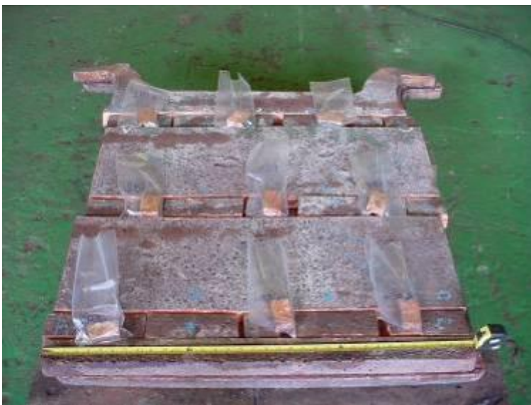
Figura 7: Foto da placa de anodo e amostras selecionadas para análise
