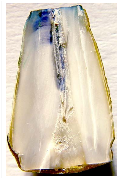
Figura 5 - Imagem que demonstra a infiltração de 6mm do corante azul de metileno no espécime 1 do Grupo I (Apic Br) (MARQUES, 2004)
