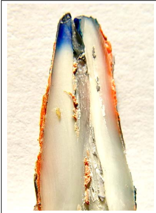
Figura 17 - Imagem que demonstra a infiltração de 3mm do corante azul de metileno no espécime 38 do GrupoVII ( Er400mJ/06Hz+ Vitremer ) ( MARQUES, 2004)
