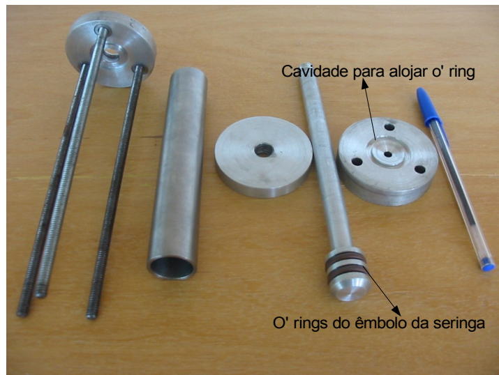
Figura 3.15: Peças da seringa fabricada.
