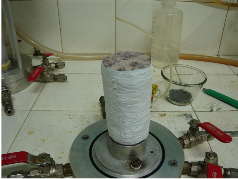
Figura 3.27: Corpo de prova envolvido com fita de teflon.
