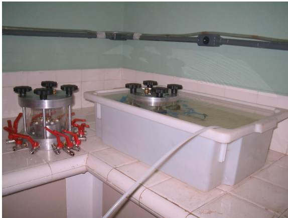
Figura 3.8: Realização de testes para verificação de vazamentos nos permeâmetros.
