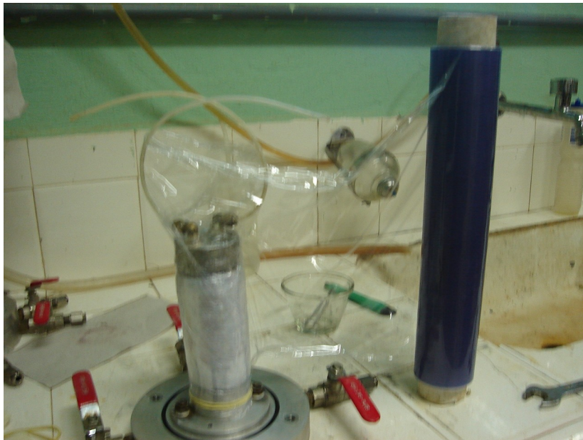
Figura 3.28: Corpo de prova sendo embrulhado com filme de PVC.
