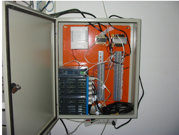
Figura 3.19: Painel eletrônico para possibilitar aquisição de dados, permitindo a automatização dos ensaios.
