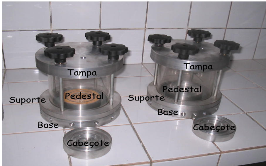
Figura 3.3: Partes que compõem os permeâmetros (base, tampa, suporte, cabeçote e pedestal).
