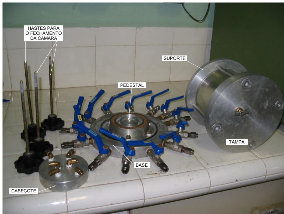
Figura 3.4: Permeâmetro desmontado com as conexões e registros.
