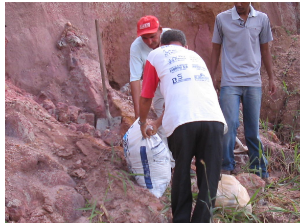
Figura 3.26: Foto mostrando o procedimento de coleta das amostras de sedimento Barreiras.
