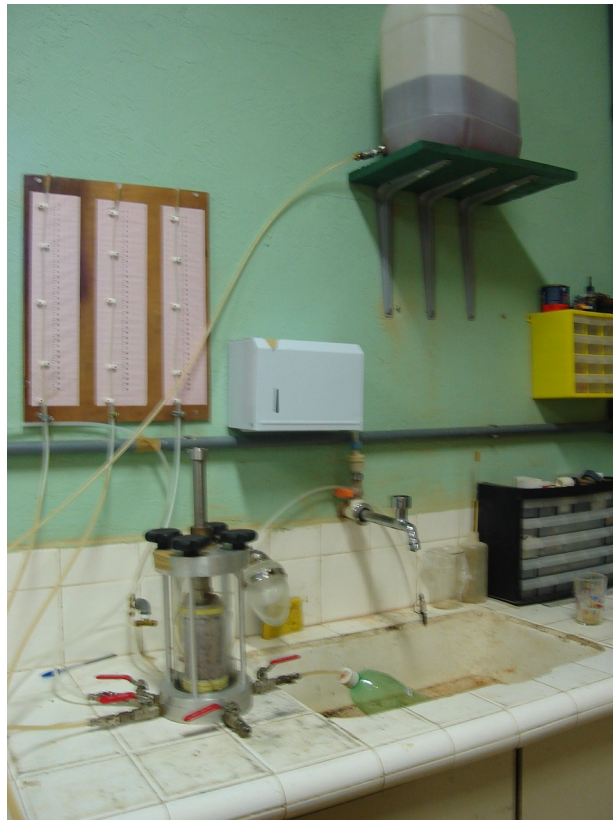
Figura 3.29: Montagem da realização do ensaio para determinação da condutividade hidráulica saturada em relação à gasolina (observar o reservatório no alto e garrafa plástica na saída da câmara).
