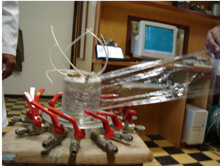
Figura 4.10: Montagem do corpo de prova utilizando filme de PVC.
