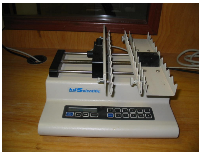
Figura 3.14: Bomba de fluxo utilizada no equipamento.
