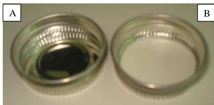
Figura 12 - Molde da prensa. (A) original; (B) adaptado
