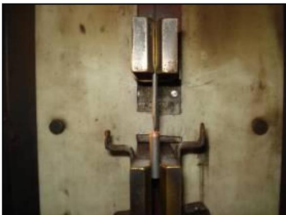
Figura 11 - Fonte de plasma do DC-ARC OES com eletrodos inferior (com amostra de cobre) e superior.
