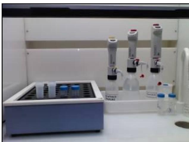
Figura 17- Bloco aquecedor *Hotblock*<sup>R</sup> SC 100.
