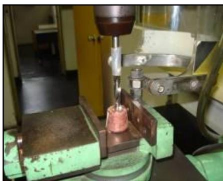
Figura 22 – Furadeira empregada para retirada de cavacos nas amostras de cone.
