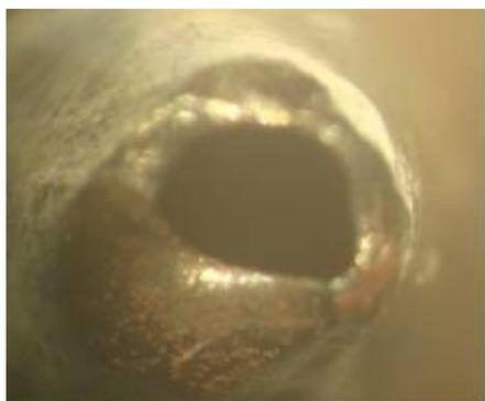
**Figura 26 – Danos causados por íons de cobre no skimmer com uso contínuo durante aproximada-mente 1 mês.**
