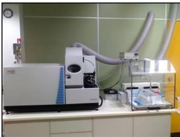
Figura 15– ICP-MS Thermo XSeries II.
