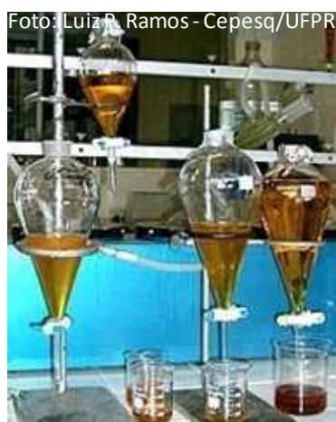
Figura 2.6. Separação da fase glicerínica durante o processo de produção de Biodiesel em escala laboratorial [Diniz 2005].
