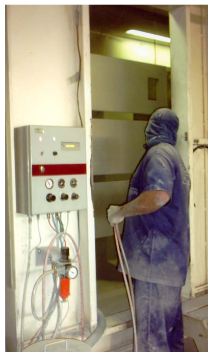
Figura 61 - Maristela Ribeiro. Pintura eletrostática dos armários de aço. 2004
