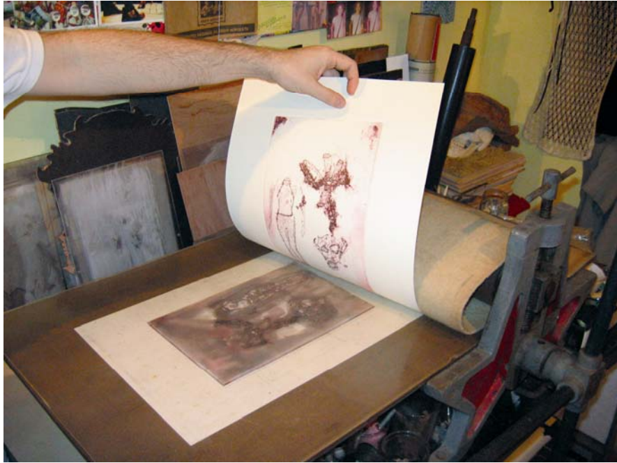
Figura 44 - Imagem do Estúdio, 2005 - Prensa Tradicional 0,50 X 0,90 m. Marca: TOPAL.
