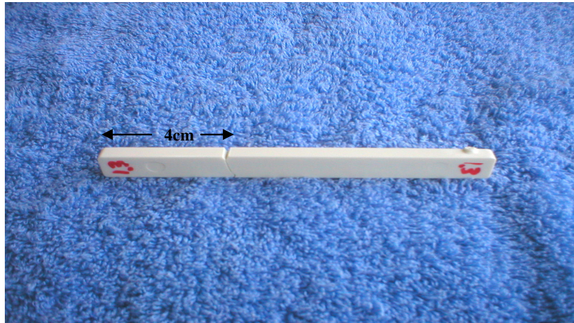
FIGURA 23 – Corpo de prova com entalhe após ensaio impacto
