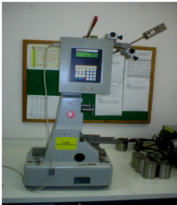
FIGURA 22 – Ensaio de impacto (Máquina Zwick)
