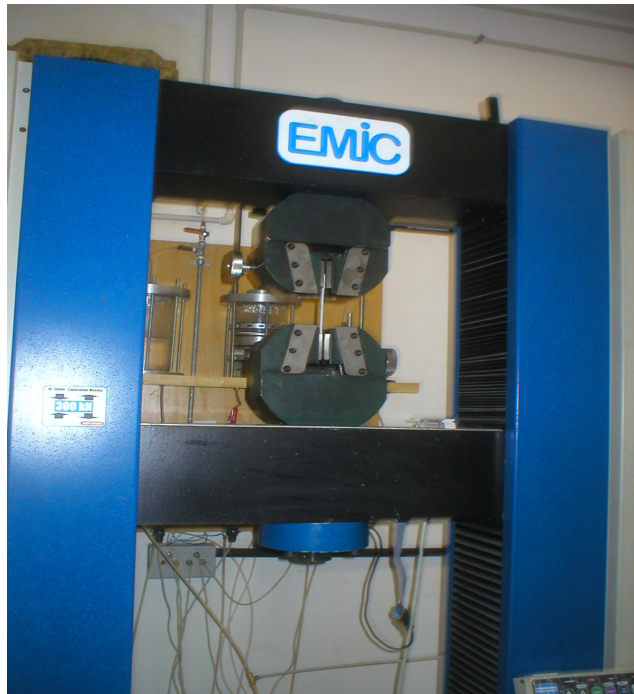
FIGURA 21 – Ensaio de tração
