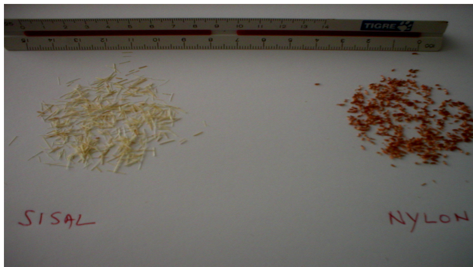
FIGURA 17 - Tamanho das fibras de nylon e de sisal
