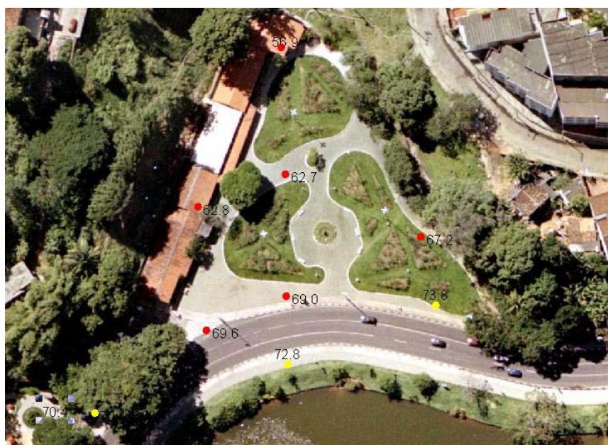
Figura 16 – Área adjacente à via de circulação de veículos - Dique do Tororó, com indicação dos Pontos Receptores e Respetivos Valores de Leq.
