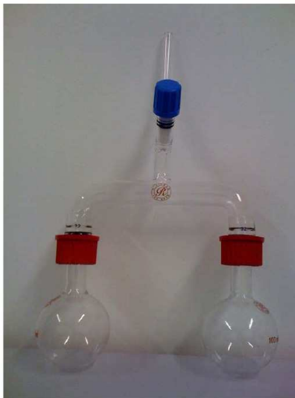
Figura 2.9: Esquema detalhado dos frascos coletor e amostrador da linha de extração - Fonte: West, et al., 2006- adaptado.
