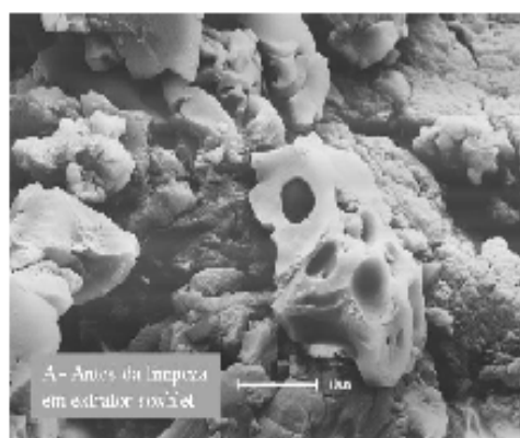
Figura 5. Microfotografia asfaltenos provenientes do arenito asfáltico (Tar sand). A- Depois da lavagem com n-hexano e antes da limpeza em extrator soxhlet. B – Depois da limpeza com n-hexano em extrator soxhlet. O aumento das microfotografias é de aproximadamente 1500x.
