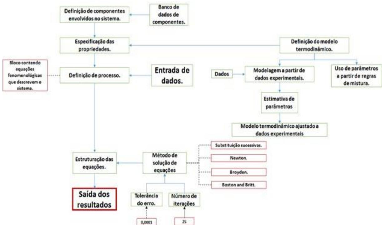
**Figura 13:** Arquitetura generalizada de simulação no Aspen Plus®.
