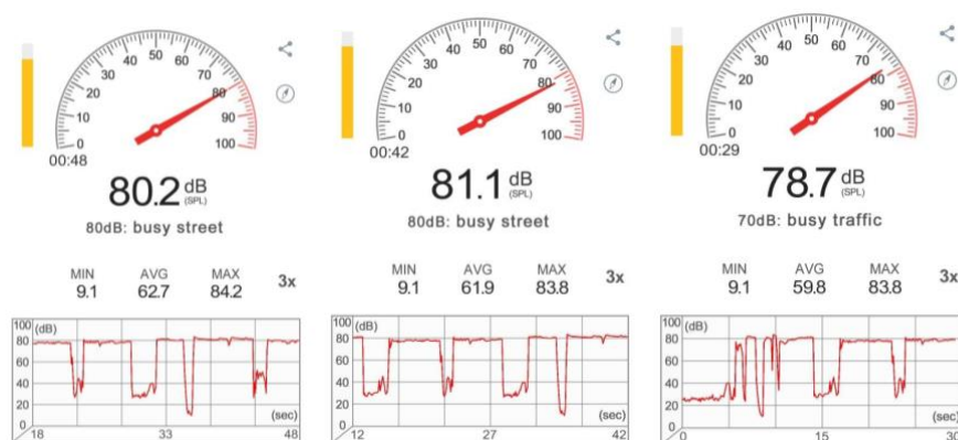
Figura 83 — Resultados de projeção sonora das notas si4, do#5 e mib5 do chalumeau impresso
