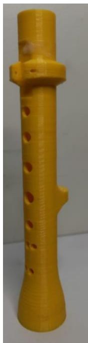
Figura 81 — Chalumeau impresso com furos superiores fechados com parafina
