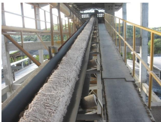
Figura 47: Transporte da areia por correia transportadora – FPM 01
