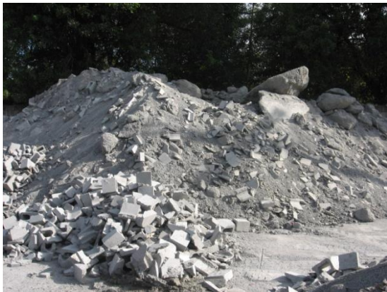
Figura 84: Resíduos de Concreto FPM 04
