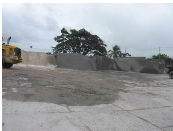
Figura 23: Baias de agregados descobertas nas centrais de concreto
