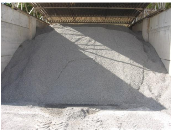
Figura 56: Baias de Agregados – FPM 04
