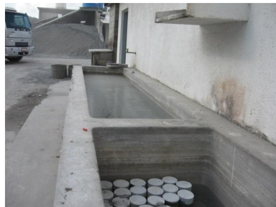
Figura 79: Tanque de cura – FPM 04
