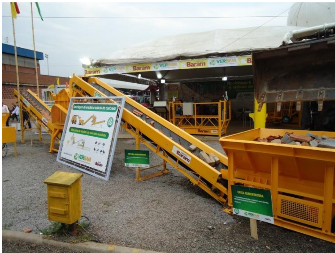
Figura 32: Usina de Reciclagem de RCC
