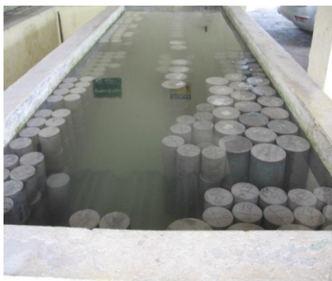
Figura 18: Tanque de Cura
