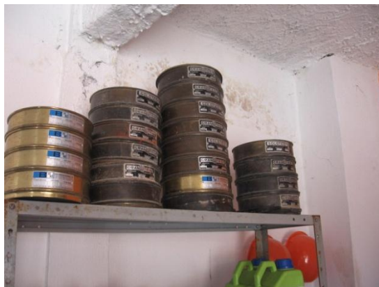
Fig. 19: Peneiras para realizar ensaios de granulometria dos agregados
