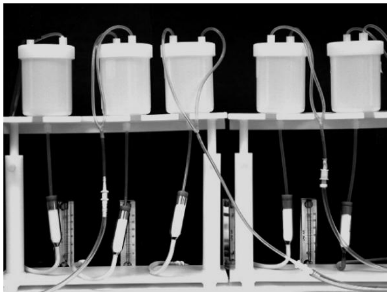
Figura 21 – Sistema de coleta de voláteis desenvolvida por Tomaszewska et al. 93
