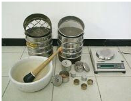
Figura Ap8 – Equipamentos utilizados para o ensaio do peneiramento
