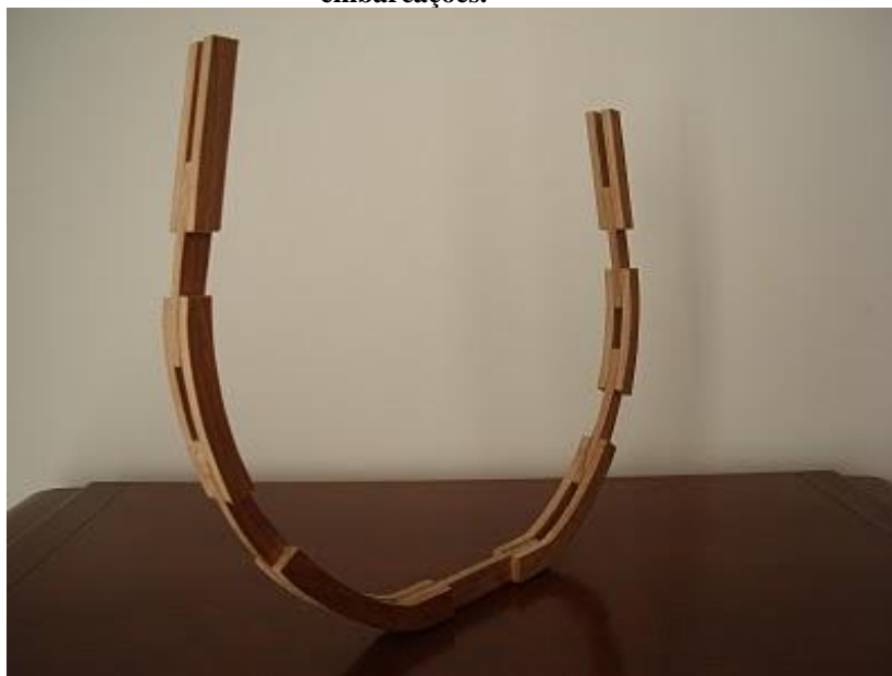
Figura 3: Cavernas e Braços na constituição do casco das grandes embarcações.
