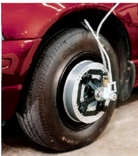
Figura 11. Wheel Force Transducer (Transdutor de Esforços em Roda).
