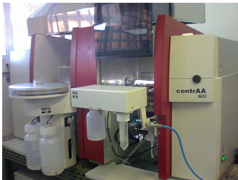
Figura 4 - Sistema de geração de hidreto (modulo HS50) acoplado ao espectrômetro CONTRAA 700 do Anlytik Jena.
