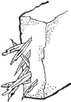
É conseguida através da criação de uma matriz independente da argila, que é formada pela associação do estabilizante (fibra) com a fração arenosa do solo. Sua eficácia depende da qualidade e da quantidade das fibras, que são responsáveis pela modificação do comportamento mecânico do material. As fibras podem ser usadas em adobes, terra-palha, blocos comprimidos, taipa de pilão ou terra empilhada.
