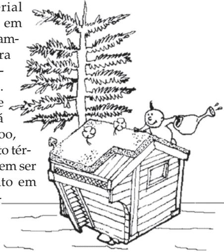
Torrões de 40 a 50cm de espessura de terra usados em cobertura chegam a propiciar uma redução de 50 a 90% das perdas de calor por isolamento, além de propiciar um melhor isolamento acústico. Este processo de isolamento térmico é recomendado, hoje, em arquitetura bioclimática.
