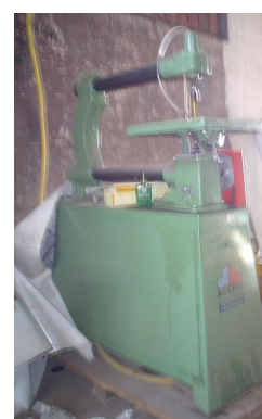
Figura 28 ó Foto de - Tico-Tico õtesouraõ.
