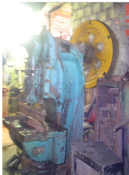
Figura 16 ó Foto de Prensa Essêntrica para ornatos em série.
