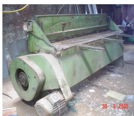
Figura 27 ó Foto de Guilhotina cortar de forma reta.
