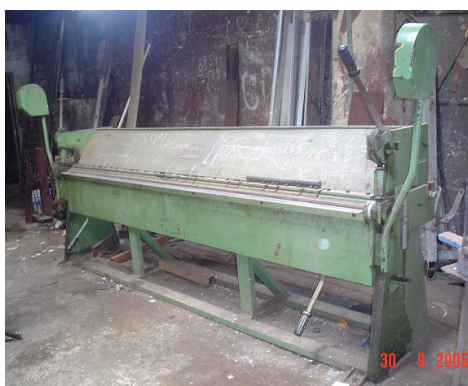
Figura 26 ó Foto de Viradeira para virar a chapa.
