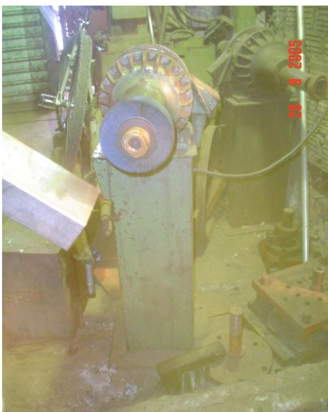
Figura 15 ó Foto de Politriz Polimento de aço inox .
