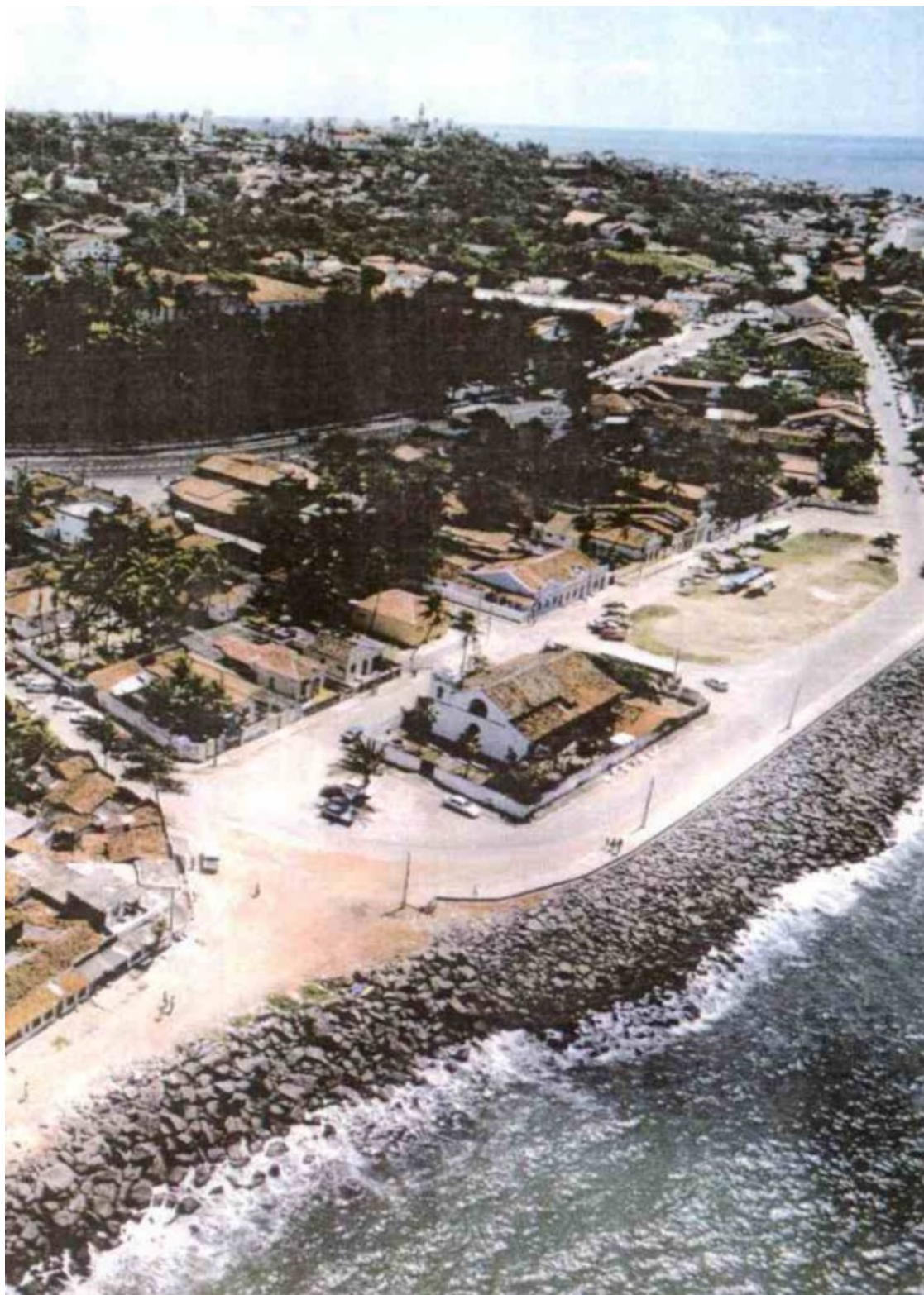
Fotografia 56 – Vista aérea da Praia dos Milagres com sua proteção de pedras contra as ressacas. 1996 99
