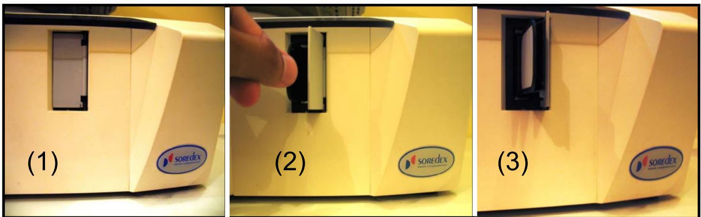
Figura 7- Scanner do sistema Digora: compartimento de leitura fechado (1), introdução do sensor para leitura (2) e sensor após a captura da imagem, pronto para uma nova exposição (3).
