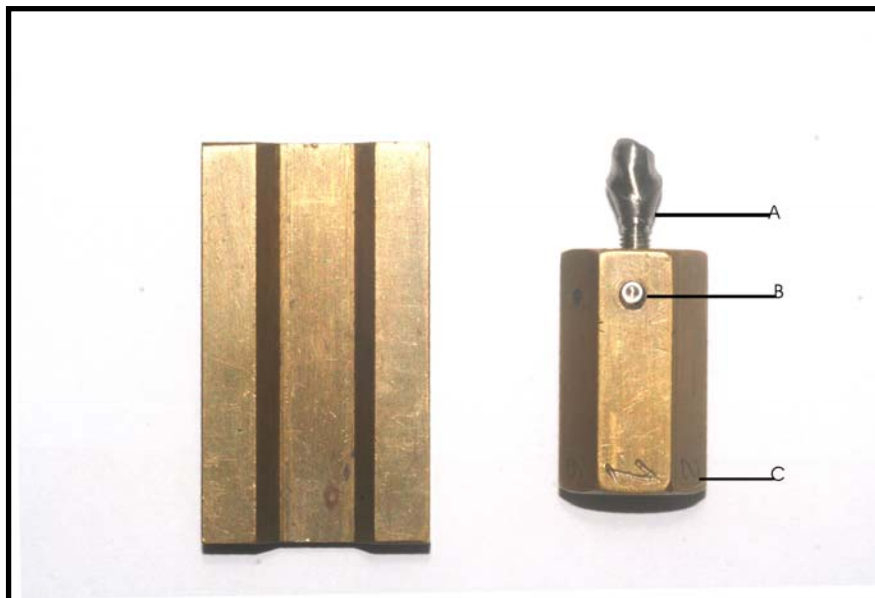
Figura 3 – Plataforma metálica de posicionamento da base metálica e implante fixado à base metálica com o pilar protético em posição: A) interface implante/ pilar-protético, B) parafuso de fixação do implante na base metálica, C) Número da face do hexágono..
