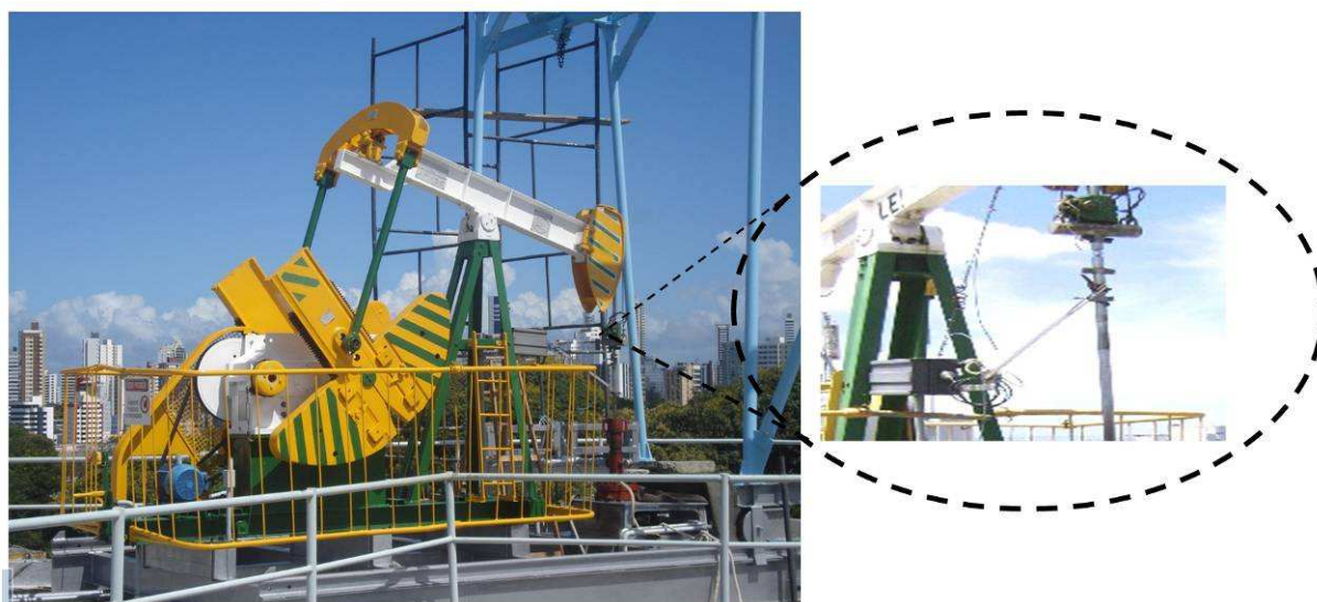
Figura 36 – UB equipada com sensores de posição e carga na haste polida
