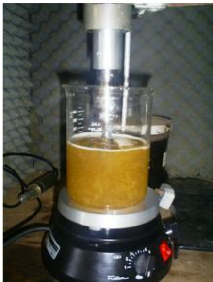
Figura 13: Sistema de transesterificação de óleo de soja auxiliado por irradiação ultrassônica.
