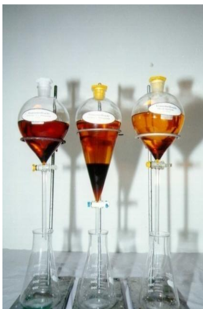
Figura 7: Processo de separação do biodiesel em laboratório.
