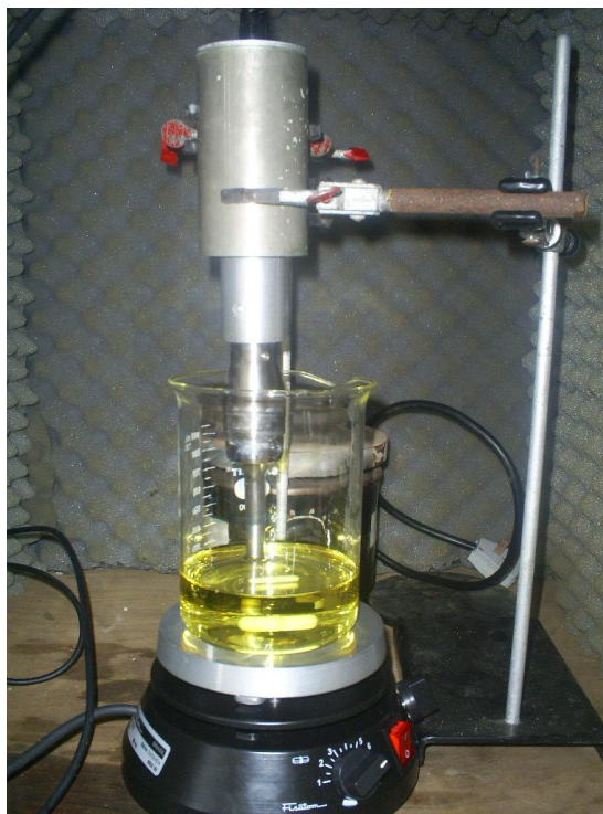
Figura 12: Sistema utilizado para realização das reações auxiliadas por ultrassom.
