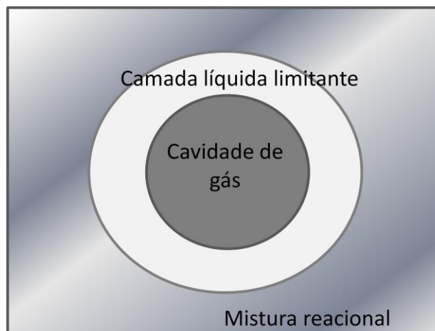
Figura 9: Modelo de duas regiões de reação sonoquímica (BARBOSA & SERRA, 1992).
