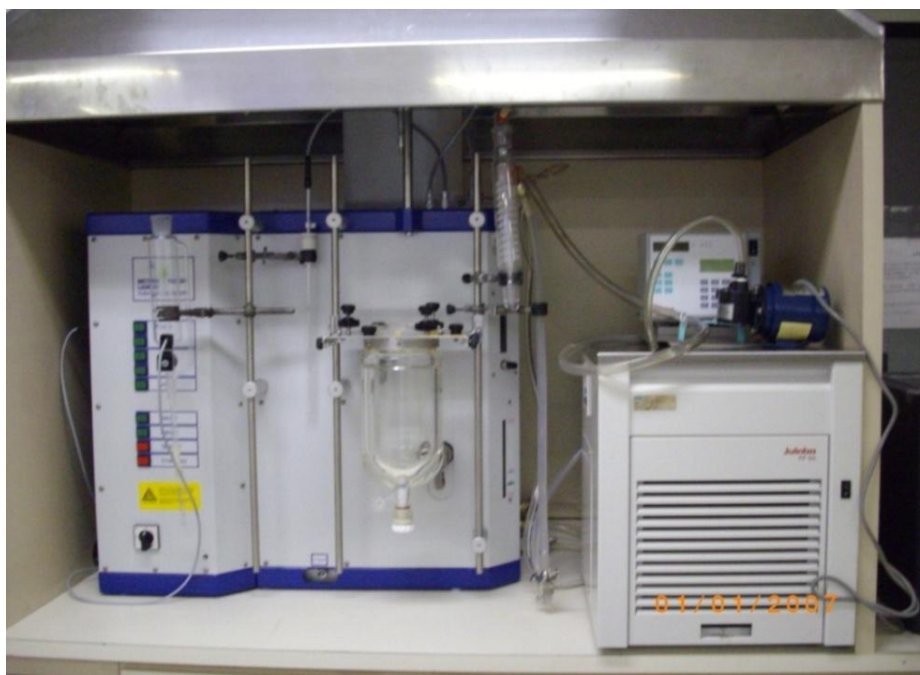
Figura 11: Reator utilizado para as reações de transesterificação convencionais.
