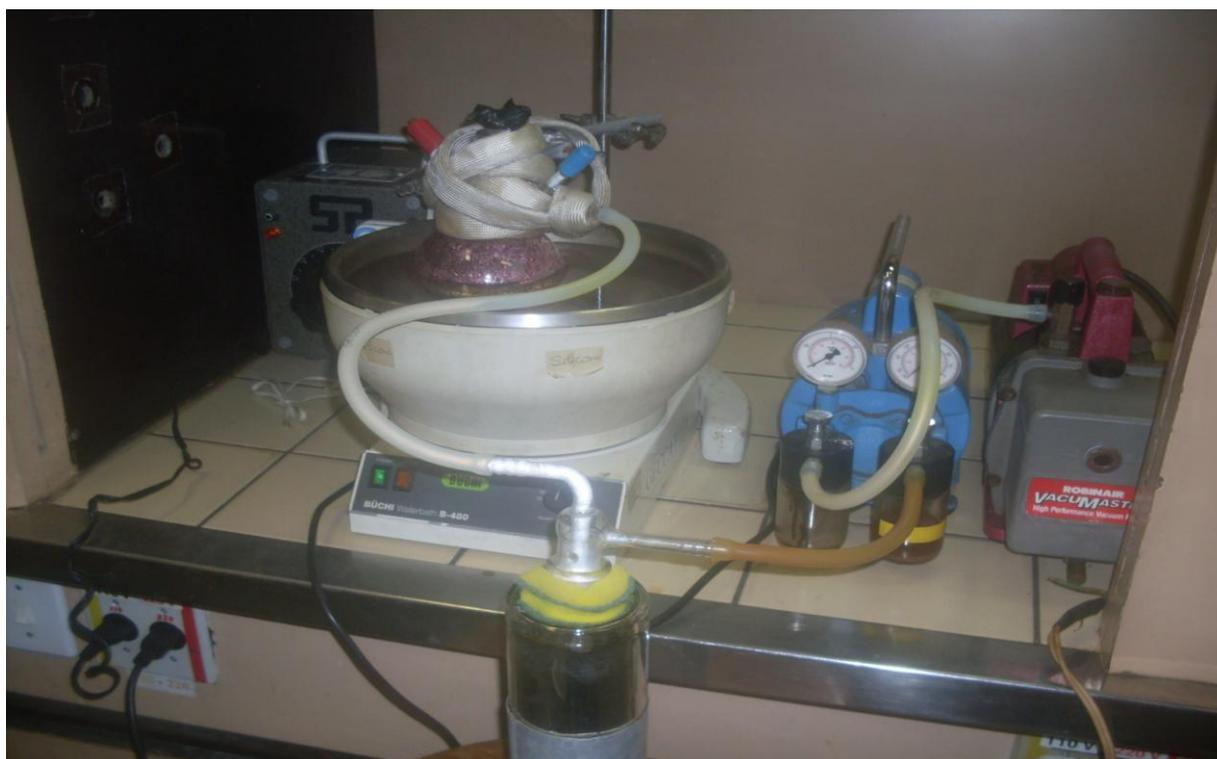
**Figura 3.1** Arranjo experimental utilizado na síntese das perovskitas pelo método de citrato.
