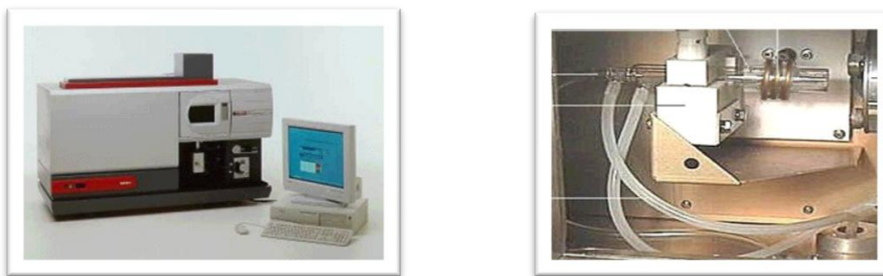
Figura 19. Espectrômetro simultâneo de emissão óptica com plasma indutivamente acoplado com configuração axial (Vista AX, Varian)
