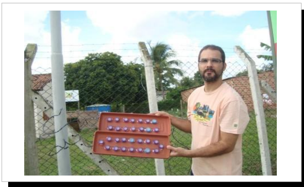
Figura 05: Foto dos amostradores passivos para monitoramento de amônia na atmosfera.
