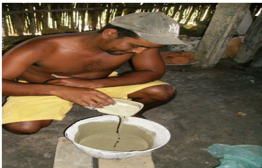
Figura 13 – Mistura da argila com o óxido de chumbo
