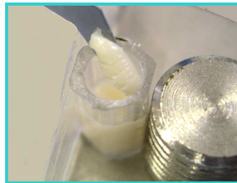
Figura 4.2B. Preenchimento dos cilindros com resina fotopolimerizável (Filtek Z250 – 3M) na cor A3.
