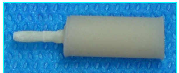
Figura 4.2P. Cilindro separado do molde de acrílico .
