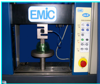
Figura 4.2T Máquina de ensaios universal – EMC 2000.
