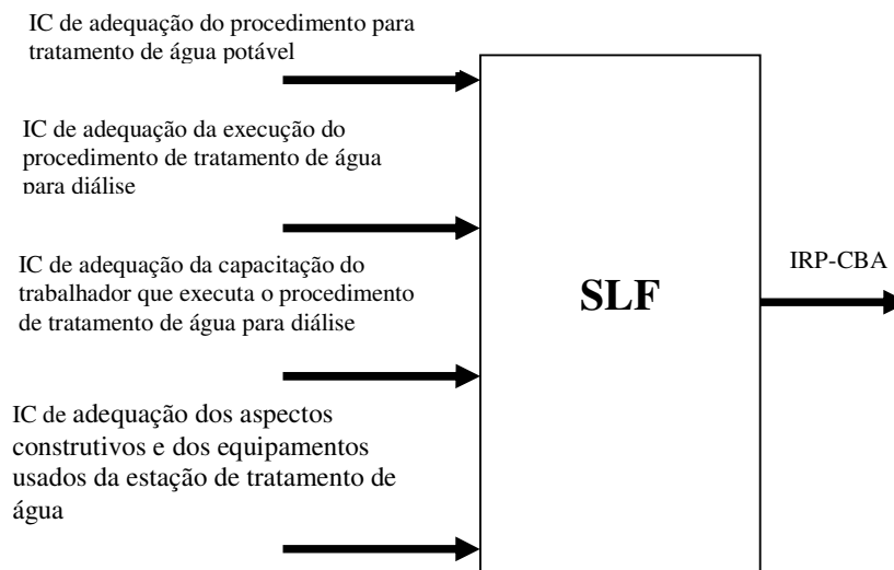
Figura 1 – Esboço do SLF para indicação de risco potencial de contaminação biológica da água para diálise
