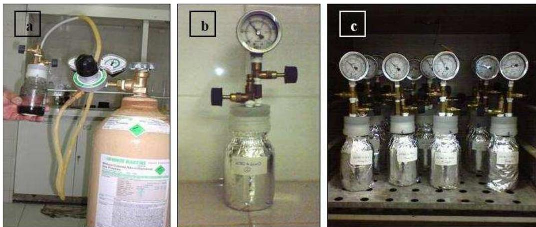
Figura 30 - Etapas seguintes do ensaio BMP: (a) Troca de atmosfera por uma mistura de N<sub>2</sub>/CO<sub>2</sub> nos frascos; (b) Fechamento do frasco e colocação do manômetro; (c) Frascos incubados na estufa a 37°C
