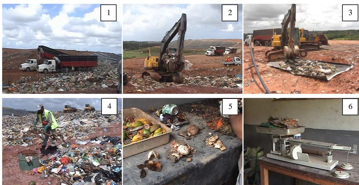
Figura 34 - Coleta de amostra de RN, segregação dos componentes e pesagem do material
