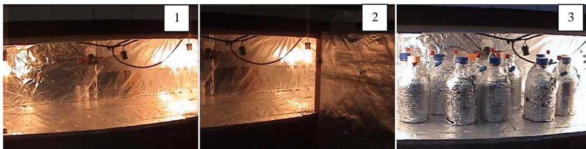
Figura 39 - Aparato experimental para confinamento dos digestores na faixa de temperatura de 38 a 40°C
