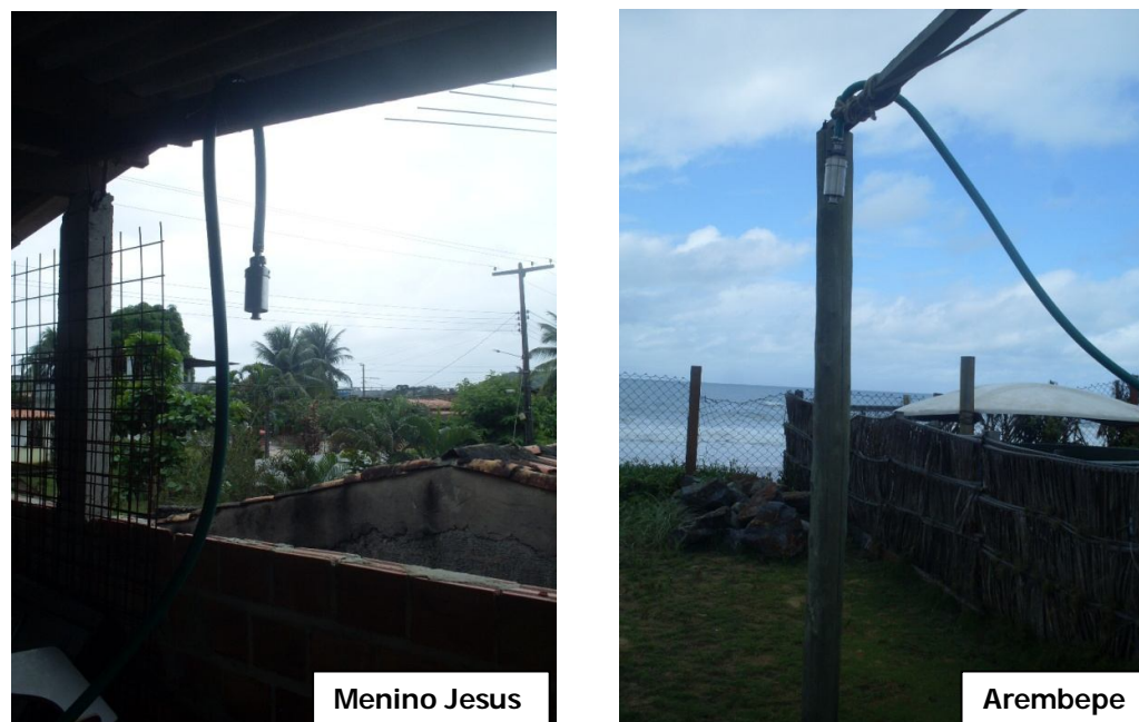
Figura 19. Impactador em Cascata (Berner) durante amostragem.
