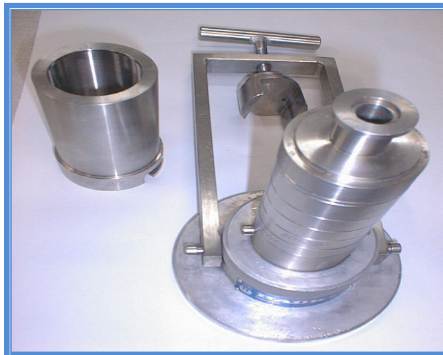
Figura 10. Impactador de Berner com 6 estágios. Fonte: autoria própria.
