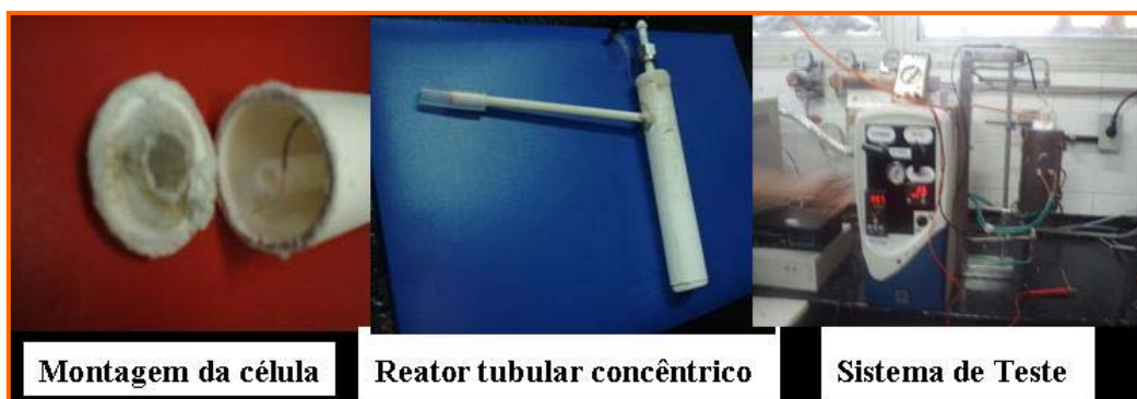
Figura 3.4. Esquema de montagem da SOFC no sistema de alimentação de combustível.
